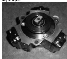
Fig. 8.29. – Pompă de înaltă presiune pentru sistem common rail
